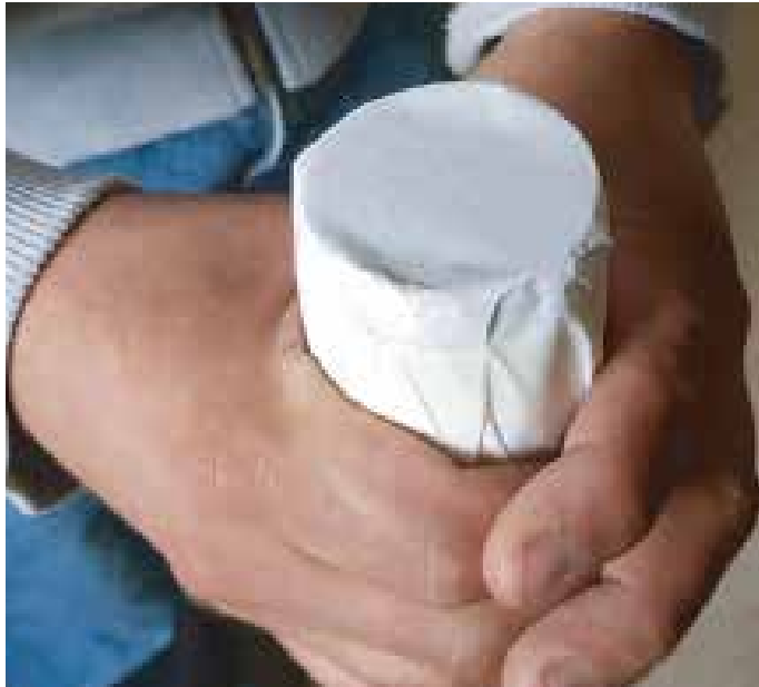
Figura 6. Instalación del papel de calcar en un extremo del tubo.
