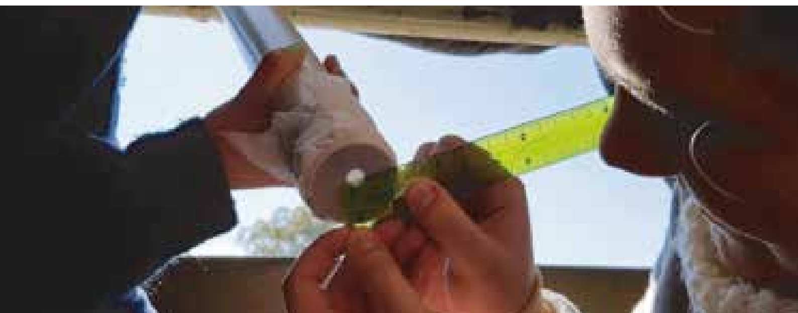
Figura 11. Medición del diámetro de la imagen del Sol en la cámara oscura.
