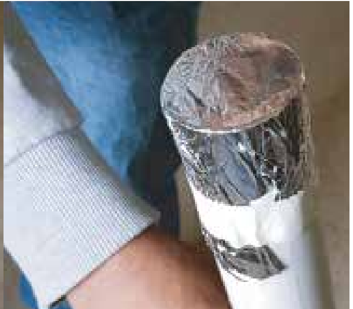
Figura 7. Instalación del papel de aluminio en el otro extremo del tubo.
